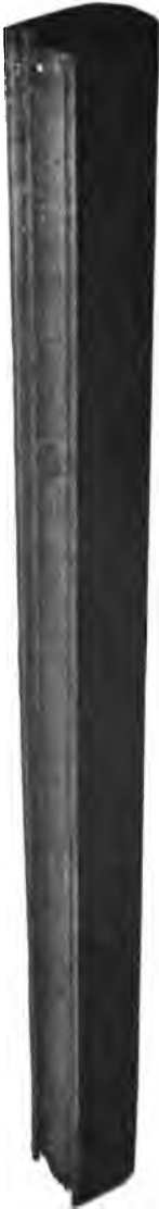
Wiege zu einer Schnellfeuer-Feldkanone System Ehrhardt. Nach dem Ehrhardtschen Preßverfahren aus einem Stück nahtlos gepreßt.
